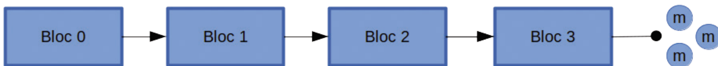
Schéma 1 : Une blockchain, et des mineurs (« m ») travaillant de concert pour la prolonger
